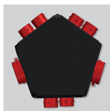
PLENUM UNI EXT 6+1 Plénium aislado de extracción con descarga Ø 125/150-160 mm, 1 embocadura para cocina Ø 125 mm y hasta un máximo de 6 embocaduras sanitarias Ø 80 mm.
