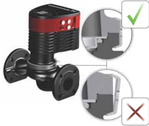
Fig. 9 Instalação da cabeça do circulador no corpo do circulador
